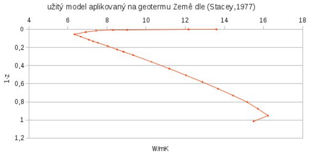
Obrázek 3.27: Funkce teplotní roztažnosti a tepelné vodivosti dle rovnic (3.2) a (3.3), a to pro model geotermu Země dle (Stacey, 1977).
