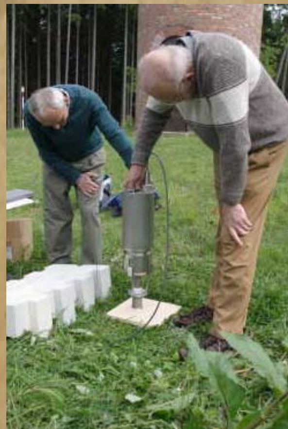
Seismometr CMG-3TD před spuštěním do vrtu
